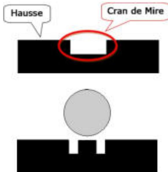
La visée pistolet : guidon centré dans le cran de mire, positionné sous le visuel
